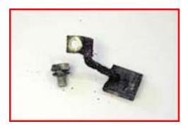
So sollte die ausgebaute Bürste ungefähr aussehen. Eine Marke zeigt Dir an, ob die Kohle noch innerhalb des Toleranzbereiches vorhanden ist.
