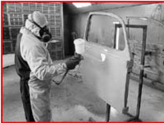
Alle abgeschraubten Teile werden am besten auf diversen Ständern befestigt und einzeln lackiert. Bei senkrecht stehenden Teilen ist die Gefahr, dass Lack ab rinnt, sehr groß. Daher lieber weniger auftragen und zwei Mal drüber gehen.
