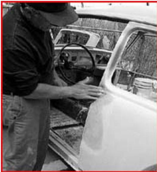
Mit den Fingerkuppen fühlst Du jede Unebenheit. Umso genauer und sorgfältiger Du in dieser Phase arbeitest, desto besser wird später das Ergebnis!
